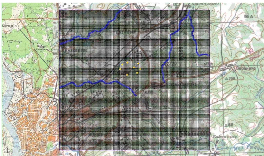
Рисунок 19 – Конечно-разностная сетка области фильтрации размерностью  $150 \times 150$  ячеек
