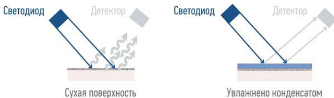
Рисунок 13 - Оптическая схема регистрации слоя углеводородного конденсата на охлаждаемом зеркале в гигрометре Ametek model 241CE II
