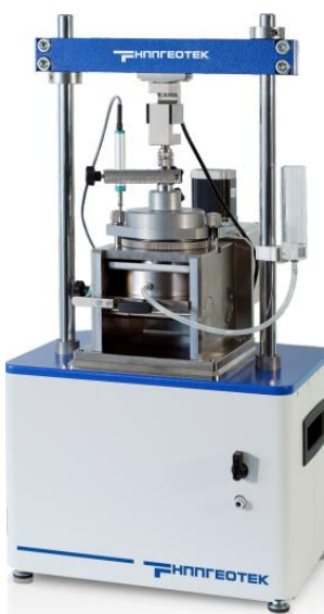
Рисунок 3.4.7.1. Автоматизированный испытательный комплекс АСИС одноплоскостного среза (Криология)
