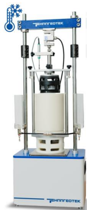
Рисунок 3.4.7.1. Автоматизированный испытательный комплекс АСИС – морозное пучение (Криология)
