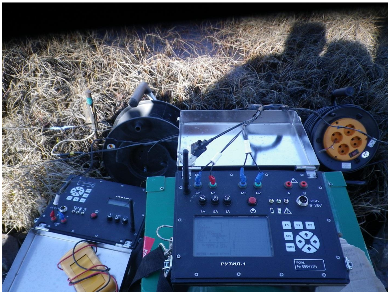
Рисунок 3.4.6.2. Комплекс электроразведочный измерительный «Рутил-1»
