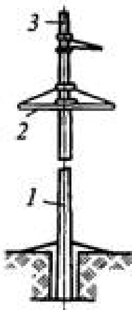
Рисунок 3.2.1. Промежуточная железобетонная опора ВЛ напряжением 110 кВ
