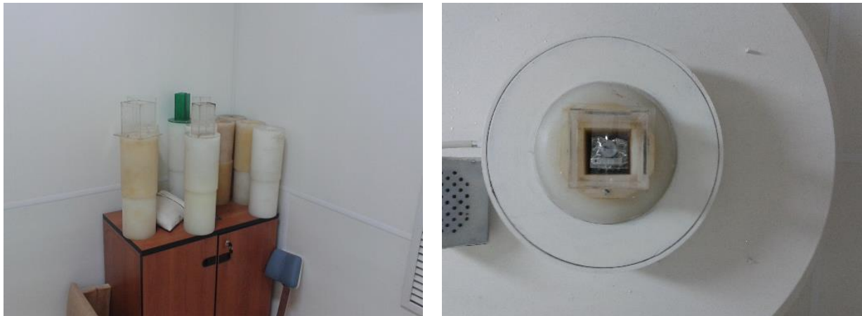
Рис 2.10. Коллиматор и схема расположения образцов (справа) и съемные полиэтиленовые коллиматоры разных размеров (слева).
