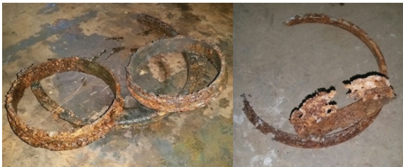
Рис. 4. Коррозионное разрушение уплотнительных колец из стали 20X13
