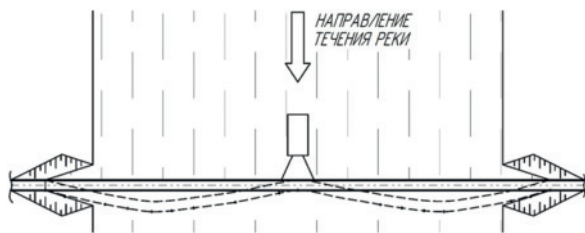
Рис. 3. Схема установки бонового заграждения с одной оттяжкой (вариант нагружения бонового заграждения распределенной нагрузкой q=q_{\max} при \alpha=90^\circ )
