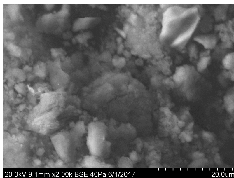
Рисунок 3.6 – Микрофотография гибридного материала МС-НА (50%) после сорбции ионов Cd 2+
