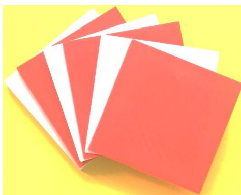
Рисунок 2.5 – Внешний вид изготовленных пластин из АБС (красный) и HIPS (белый) пластиков
