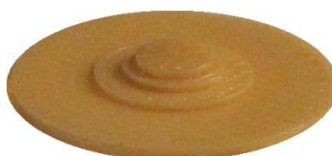
Рисунок 3.5 – Выравнивающий фильтр, изготовленный из АБС-пластика
