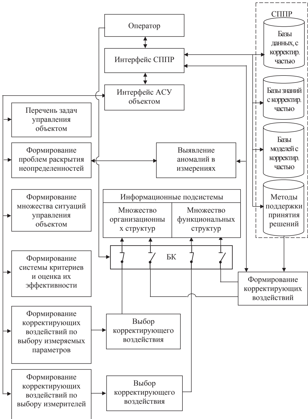
Рисунок. Схема информационной поддержки операторской деятельности в условиях неопределенности (вариант). АСУ – автоматическая система управления; БК – блок коммутации
