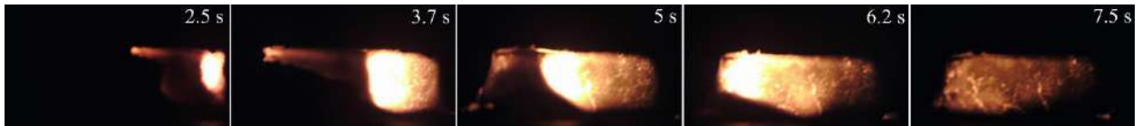
Рис. 3.29. Горение нанопорошка алюминия в воздухе
