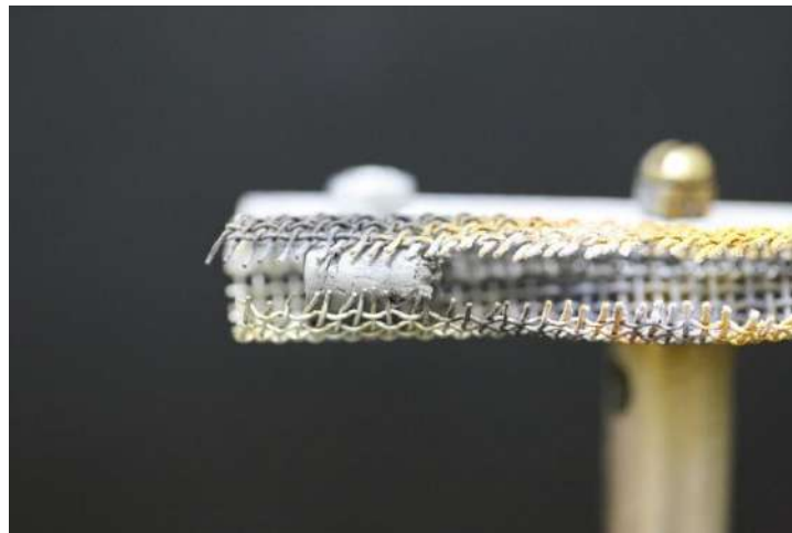
Рис. 3.31. Внешний вид твердого топлива АСД-6М, закрепленного с помощью сеточного каркаса
