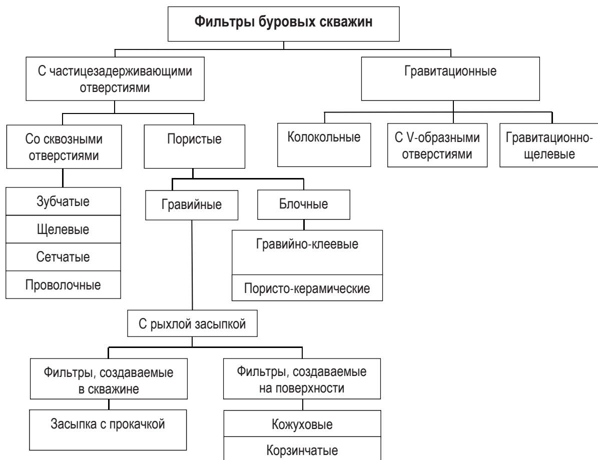
Рис. 1. Классификация фильтров буровых скважин
