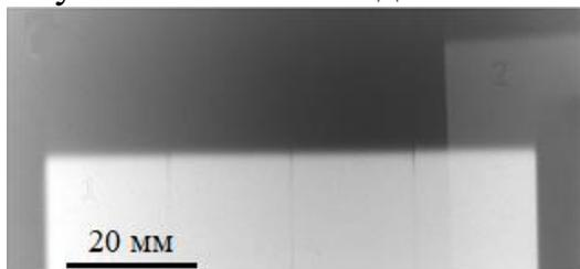
Рисунок 10 - Изображения образца с 10 мкм зазорами между блоками
