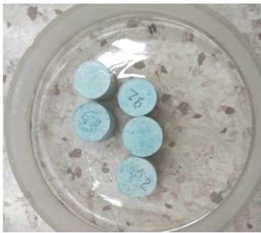
Рисунок 4.42 – Фотография окрашенных образцов после эксперимента на проницаемую пористость
