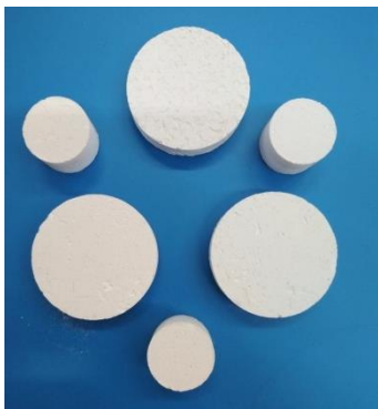
Рисунок 4.41 – Фотография образцов в форме дисков и цилиндров после утильного обжига
