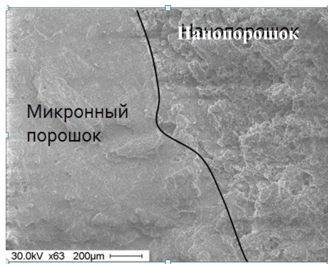
Рисунок 3.13 -Микрофотография разреза (вдоль расположения нити) образца, полученного с использованием импрегнированной хлопковой нити
