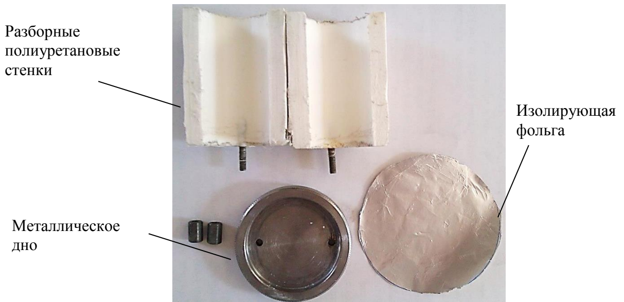
Рисунок 4.4 - Фотография комбинированной формы с металлическим дном и полиуретановыми стенками
