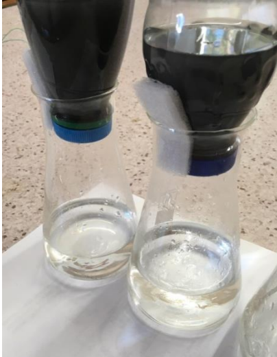
Рисунок 4.47 – Фотография очистки водной суспензии наноразмерного порошка алюминия пропусканием через керамический фильтр ( ZrO_2 ) с хаотичной пористостью
