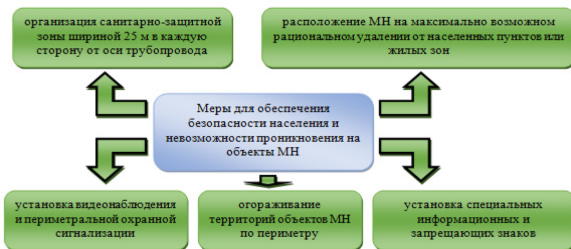
Рисунок 5.6 – Меры для обеспечения безопасности населения и невозможности проникновения на объектах МН
