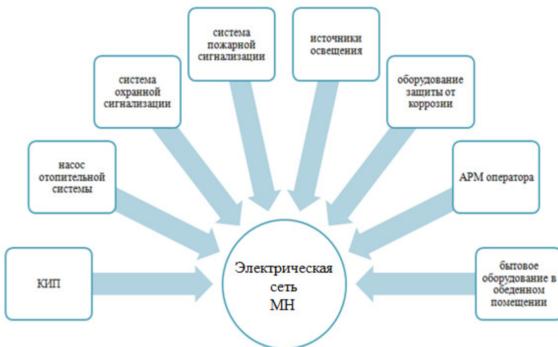
Рисунок 5.2 – Объекты, подключенные на МН к электрической сети
