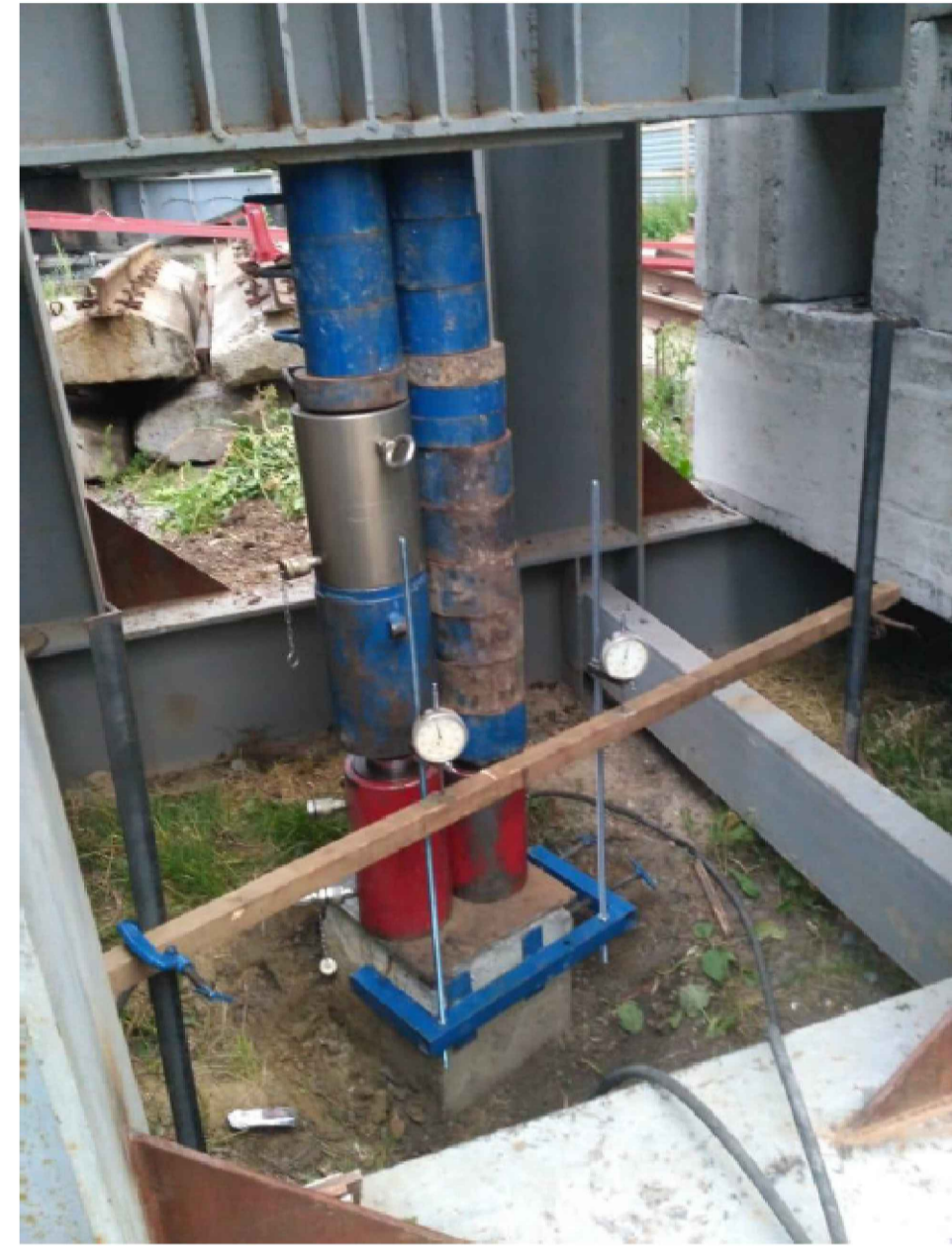
Результаты испытания грунтов сваями типа С160.35-10 (1, 2)
