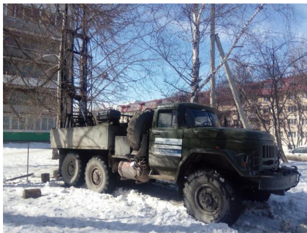
Рисунок 4 - Буровая установка УГБ-1ВС на базе ЗИЛ – 131
