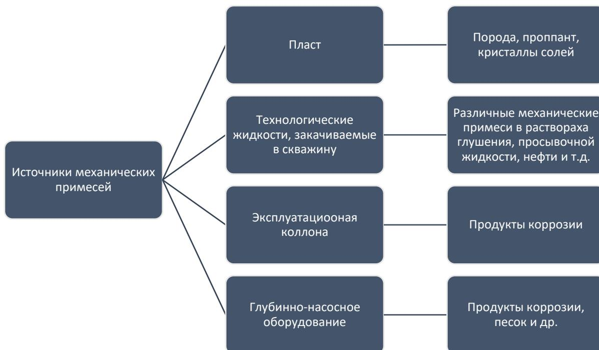
Рисунок 1.5 – Классификация источников механических примесей в работе добывающих скважин
