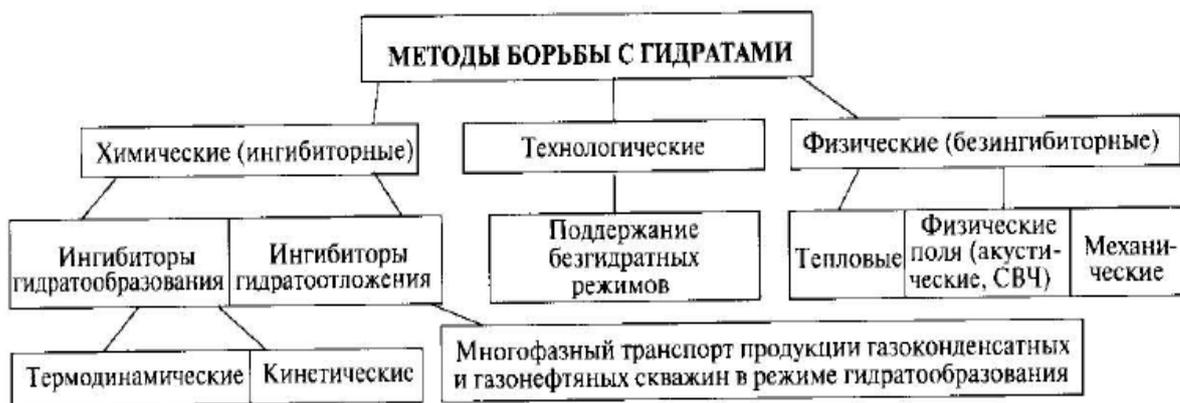
Рисунок 1.10 – Методы борьбы с газовыми гидратами в разработке нефтегазовых месторождений
