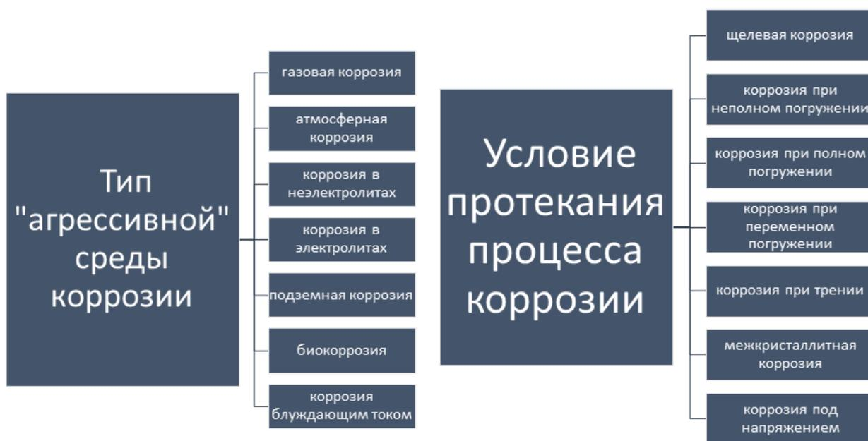
Рисунок 1.3 – Классификация коррозии по типу агрессивной среды и условию ее протекания в скважине и скважинном ДО
