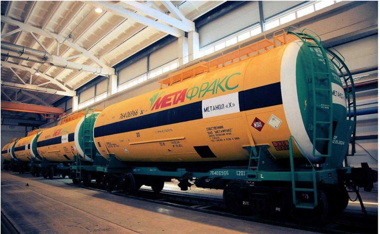
Рисунок 5.3 – Вагон-цистерна для перевозки метанола или других химических реагентов
