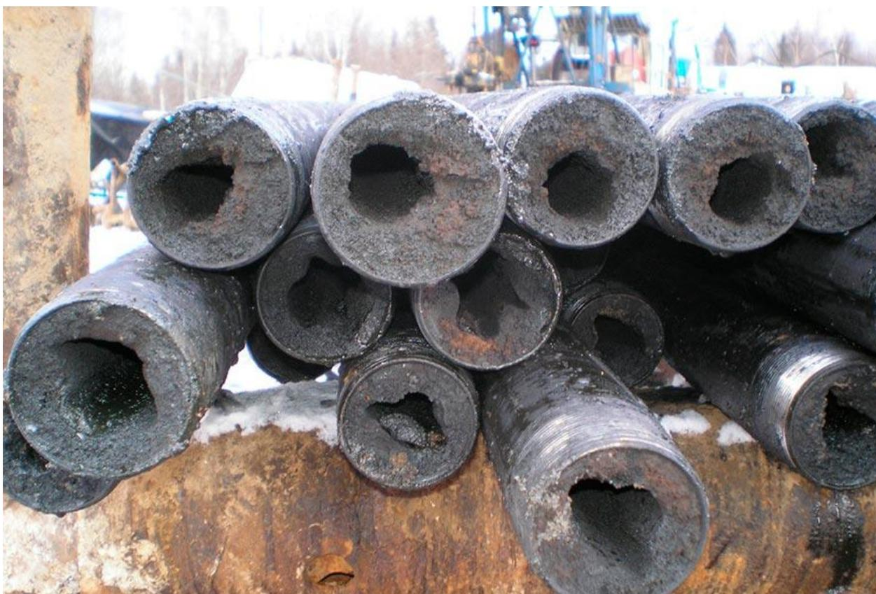
Рисунок 1.1 – Пример асфальтосмолистых парафиновых отложений в НКТ в добывающих скважинах месторождений нефти и газа Западной Сибири
