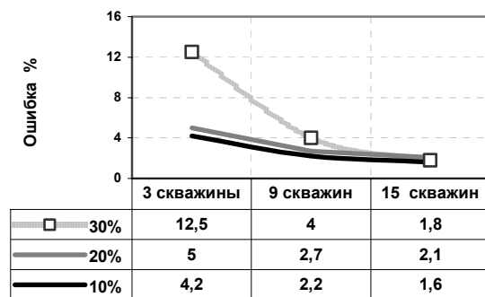
Рис.5. Зависимость средних ошибок прогноза суммарного дебита от числа добывающих скважин при различном уровне вносимых погрешностей
