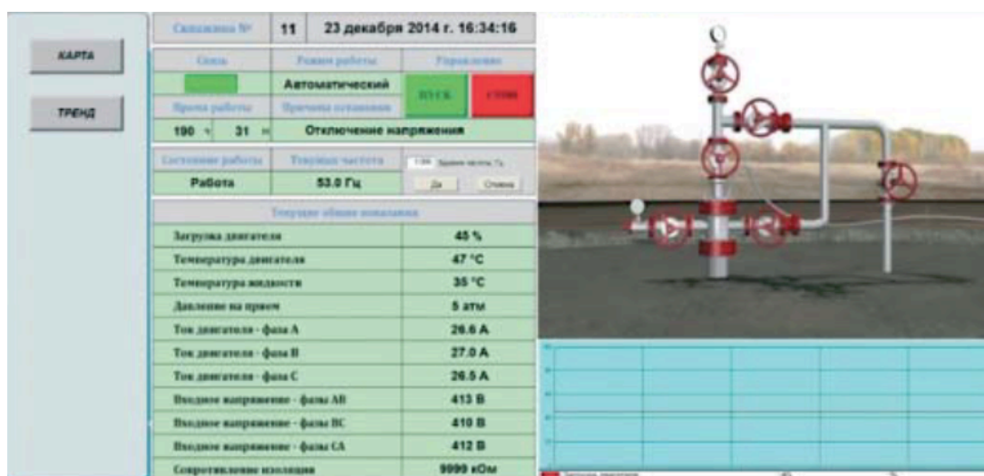
Рисунок 7 – Пример системы контроля параметров скважины, оборудованной ЭЦН в программе MasterSCADA компании ОАО «Ульяновскнефть»
