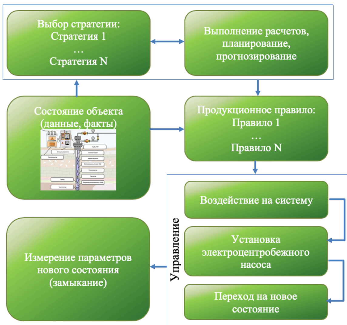
Рисунок 16 – Схема работы программного комплекса по управлению механизированным фондом
