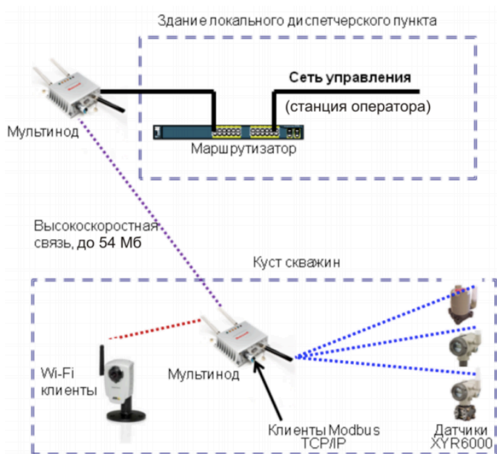
Рисунок 23 – Беспроводная система сбора и передачи информации
