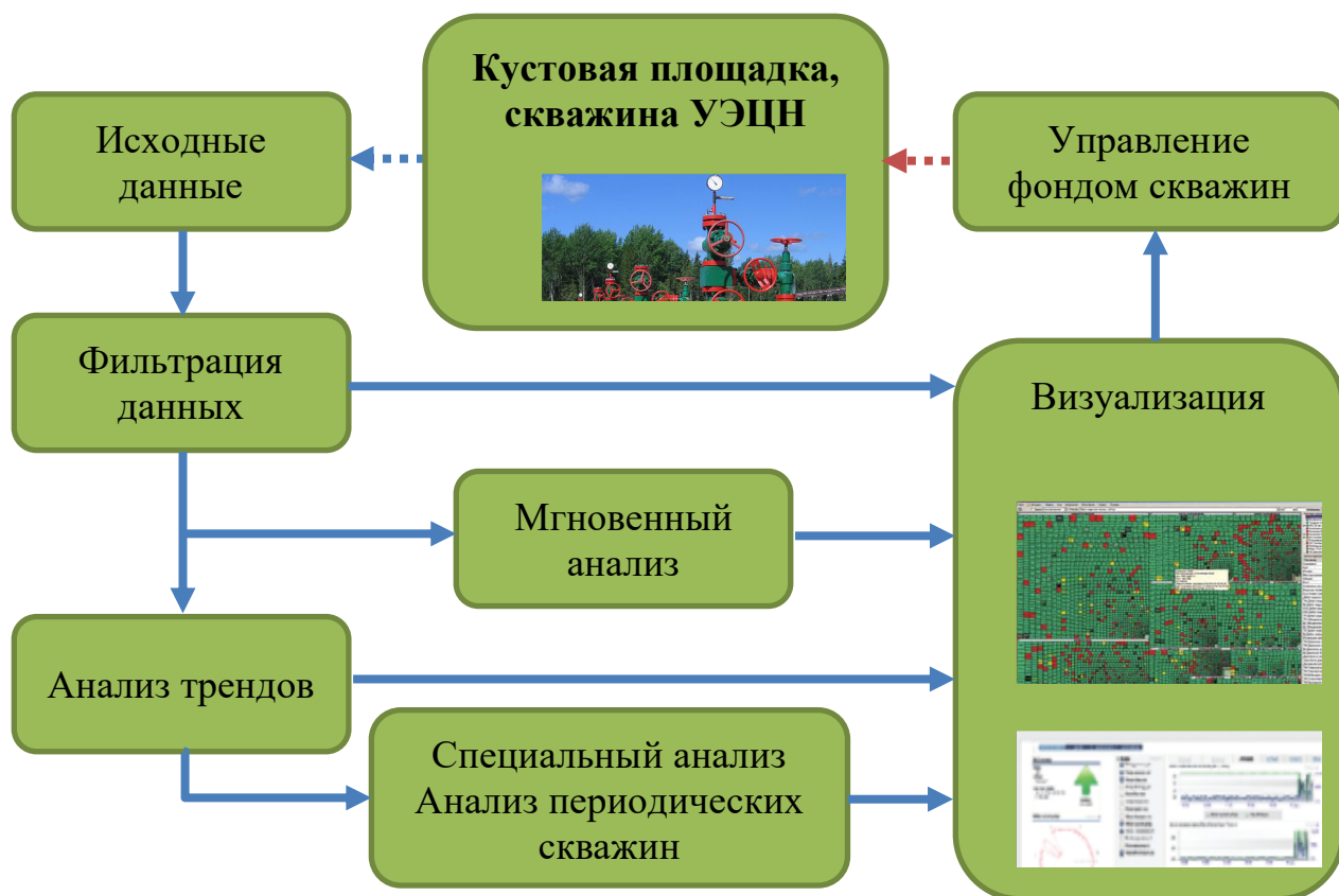
Рисунок 14 – Схема работы программного комплекса по мониторингу работы механизированного фонда
