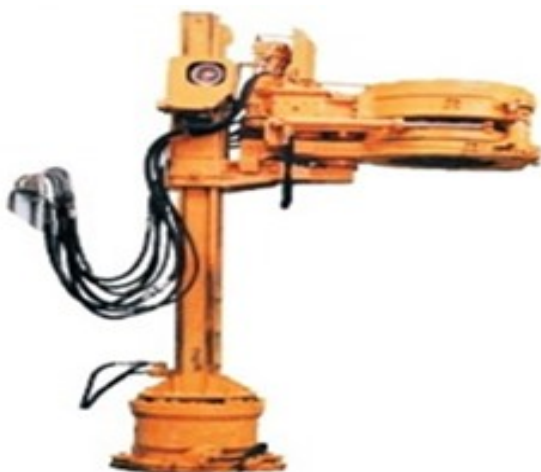
Рисунок 15 – Буровой ключ КБГ-2.
