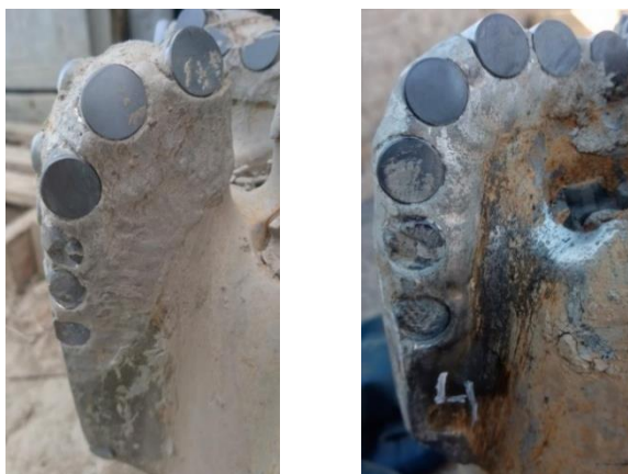
Рисунок 14 – Износ долот на калибрующей части при бурении с ВЗД (отслоение алмазной пластины, сломы и сколы PDC резцов)
