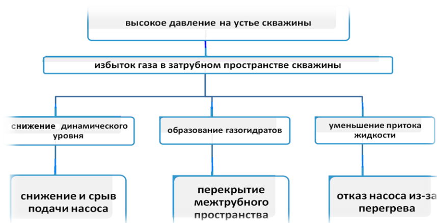
Рисунок 3 – Осложнения, возникающие при работе насосного оборудования в скважинах с высоким газовым фактором
