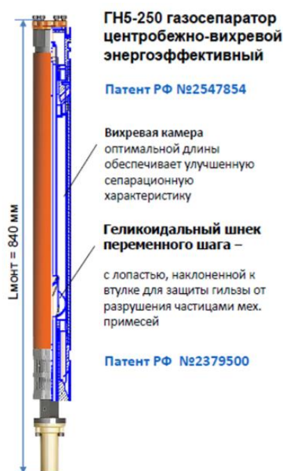
Рисунок 4 – Общий вид центробежно-вихревого энергоэффективного газосепаратора
