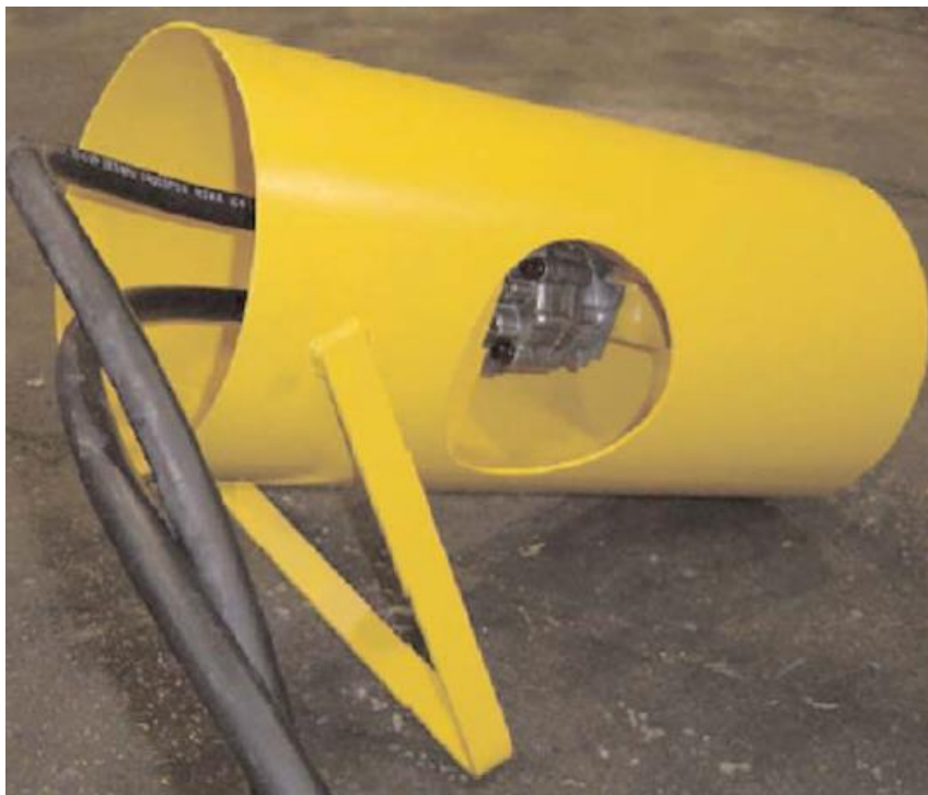
Рисунок 2.9 – Автономная гидравлическая винтовая мешалка
