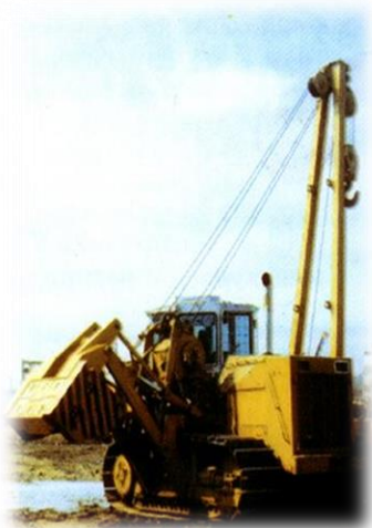
Рис. 12 Кран - трубоукладчик ТГ-221
