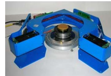
Рисунок 12. Блок инерционного тела с системой съема информации чувствительного элемента тип III
