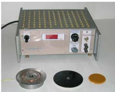
Рисунок 14. Элементы осциллятора для исследования чувствительного элемента на основе свободнопадающего инерционного тела
