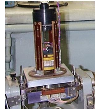
Рисунок 10. Блок инерционного тела чувствительного элемента тип II со снятым кожухом на стенде
