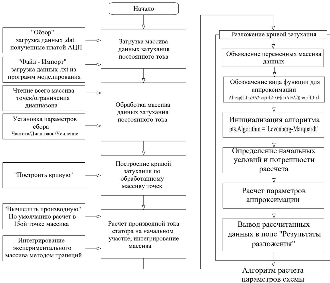
Рисунок 4.6. Алгоритм обработки массива экспериментальных данных
