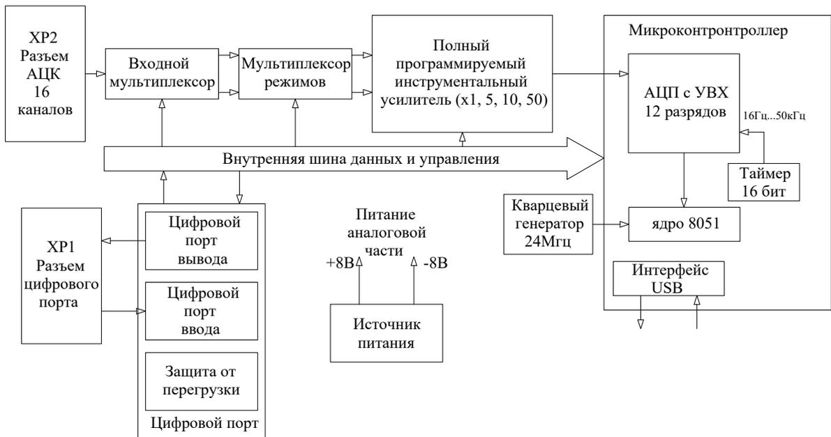
Рисунок 3.10. Блок-схема LA-20USB
