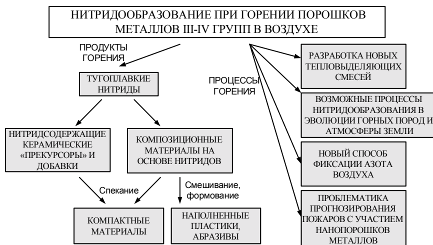
Рисунок 21 – Схема применения продуктов синтеза нитридов и оксинитридов сжиганием порошков металлов в воздухе и процессов горения
