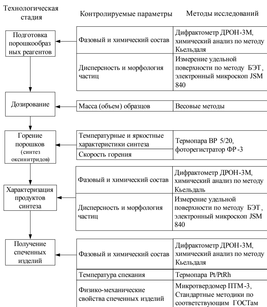
Рисунок 22 – Технологическая схема получения оксидно-нитридной керамики синтезом сжиганием порошков металлов в воздухе
