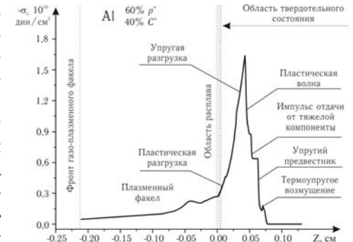
Рис. 7. Импульс механических возмущений, возбуждаемый МИП плотностью мощности 1.1 \cdot 10^9 Вт/см 2 в алюминии к моменту окончания импульса тока
