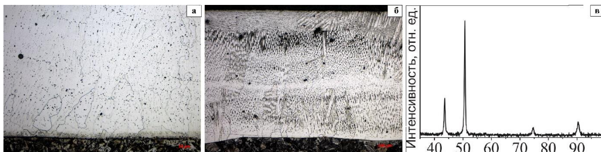
Рис. 1. Строение наплавленных слоев. а,б – микроструктура наплавленных слоев. в – рентгенограмма образца полученного по режиму 2.
