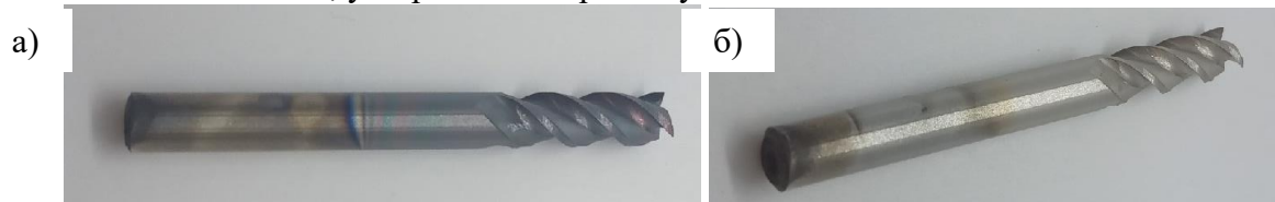
Рис. 3. Фотографии концевой фрезы с углеродным покрытием (а) до и (б) после травления покрытия.
