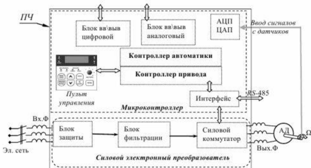
Рис. 2. Типовая структура управления асинхронным двигателем с использованием преобразователя частоты
