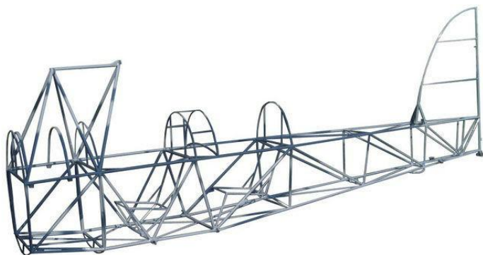
Рис. 1. Ферма фюзеляжа самолета "Шершень"
