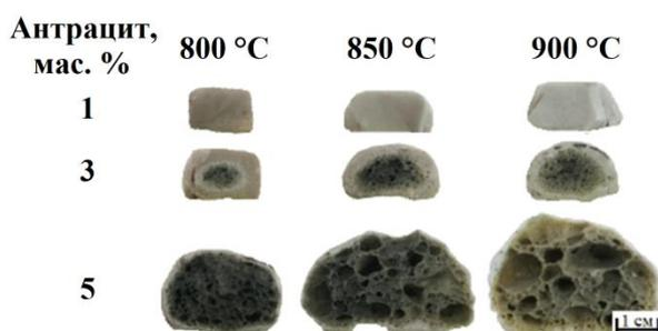
**Рис. 3.** Внутренняя структура образцов на основе углерода (антрацита)
