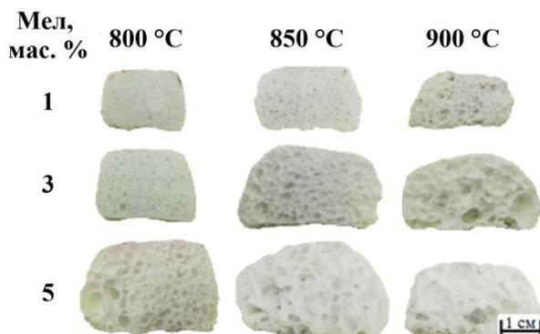
**Рис. 2.** Внутренняя структура образцов на основе кальцита (мела)
