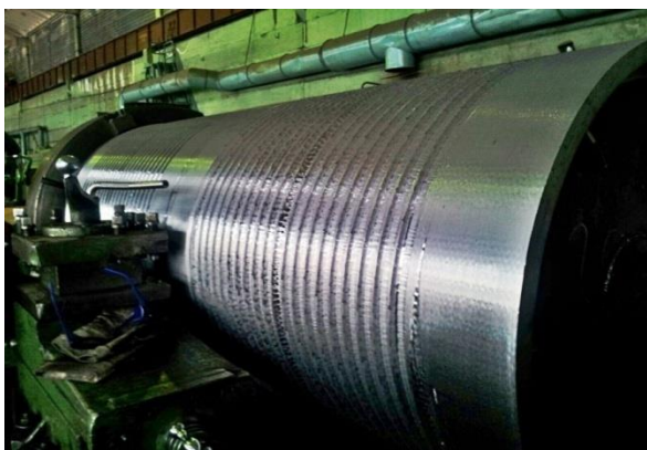
Рисунок 1.2-Нарезка канавок на барабане в цеху АО ПМЗ
