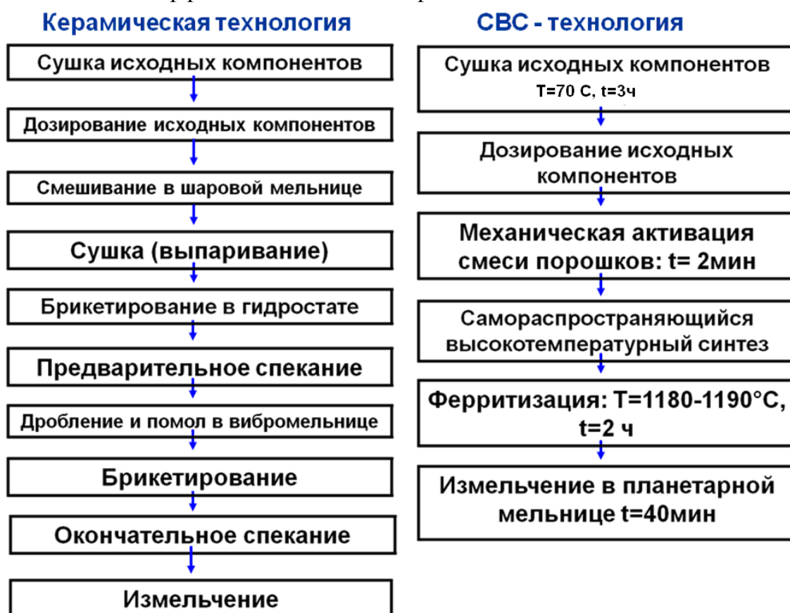
Рисунок 3 - Схема технологического процесса получения оксидных гексагональных ферримагнетиков с W-, M- и Z-структурой методом СВС с последующим спеканием.
