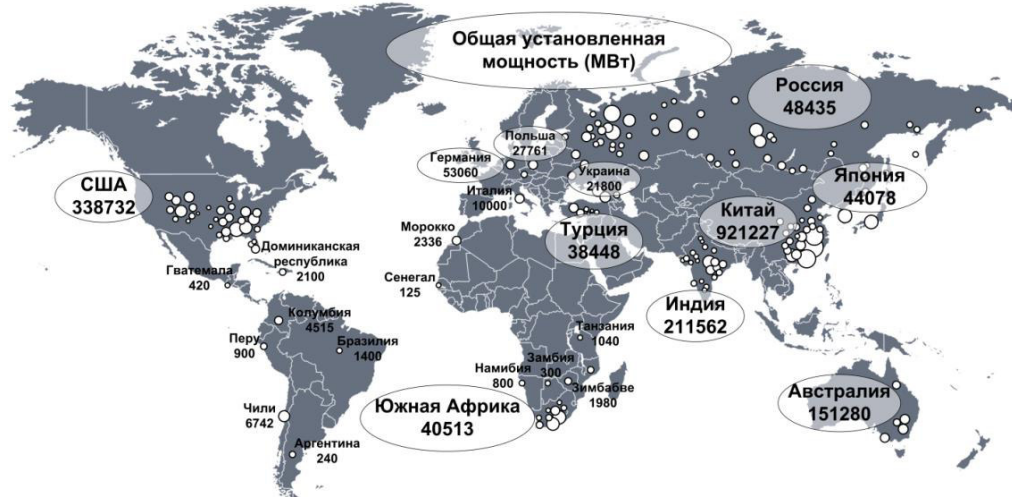
Рис. 1. Установленные мощности (МВт) угольных тепловых электростанций по всему миру (на основе данных Key World Energy Statistics. International Energy Agency, 2019; World energy resources. World Energy Council, 2016).
