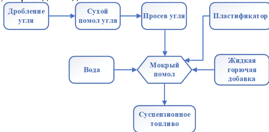
Рисунок 1 – Схема подготовки топлива
