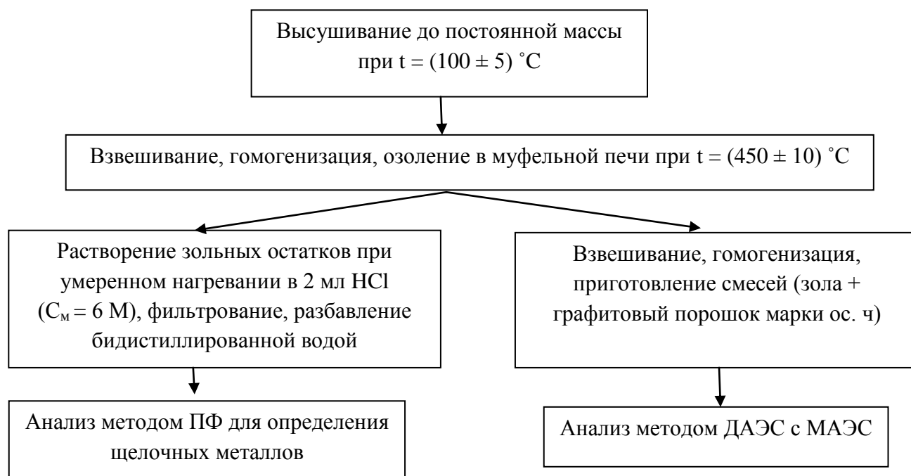
Рисунок 5 – Приемы пробоподготовки органов подопытных крыс
