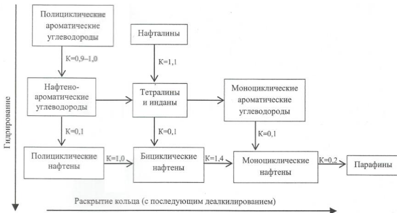
Рисунок 12 – Реакционная схема процесса гидрокрекинга
