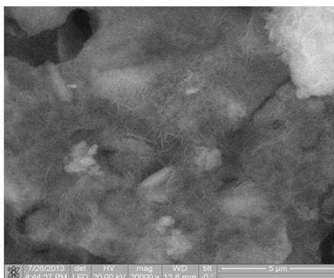
Рис. Электронная микрофотография торфомагнезиальных композиций, твердевших в воде
