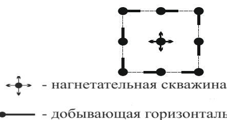
Рис.4 Девятиточечные системы заводнения с использованием горизонтальных скважин
