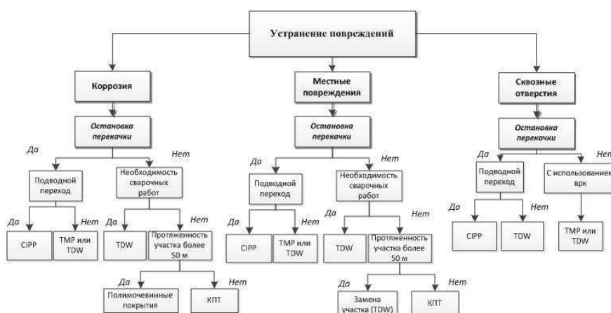
Рис. 3 Схема выбора технологии ремонта в зависимости от конкретного вида повреждений
