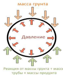
Рис. 1 Нагрузки, действующие на стенку трубопровода
