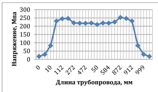
Рис. 2 График изменения напряжений по длине трубопровода
