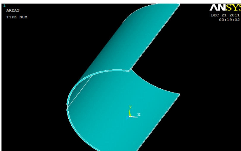
Рис.3 Модель трубы с участком сплошной коррозии
