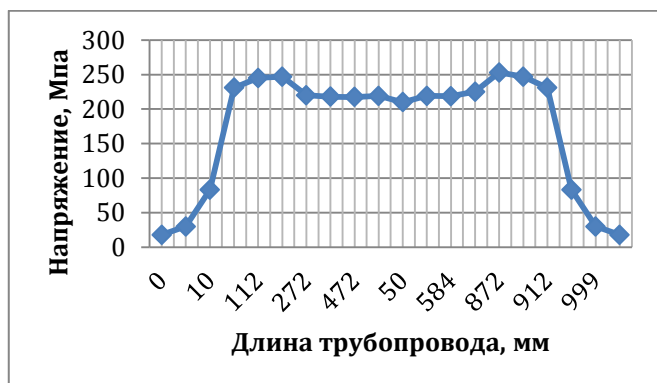
Рис. 2 График изменения напряжений по длине трубопровода
