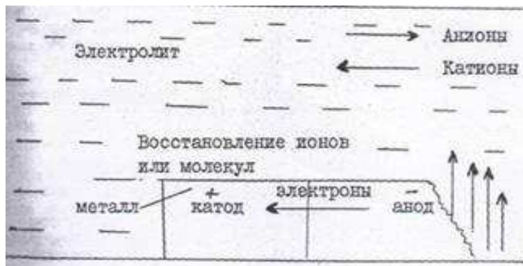
Рис.1 Процесс коррозионного разрушения металла
