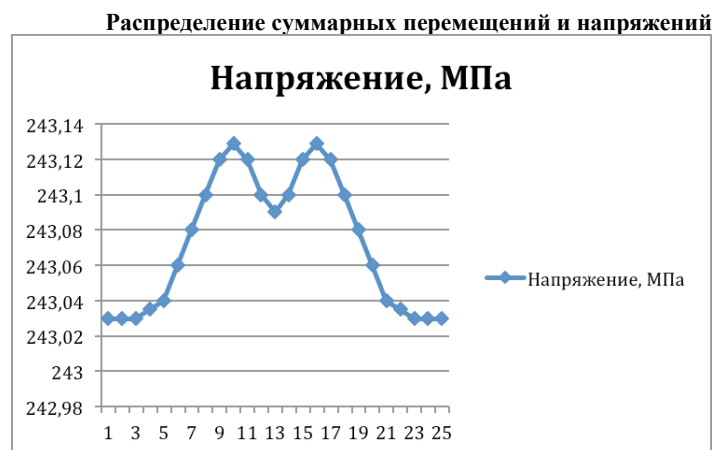
Рис 1. График изменения напряжений по длине трубопровода
