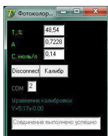
Рис.3. Главное окно программы, управляющей работой фотоколориметра
