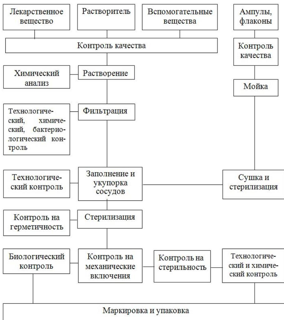
Рисунок 1.1 Общая схема технологического производства растворов в ампулах [12]
