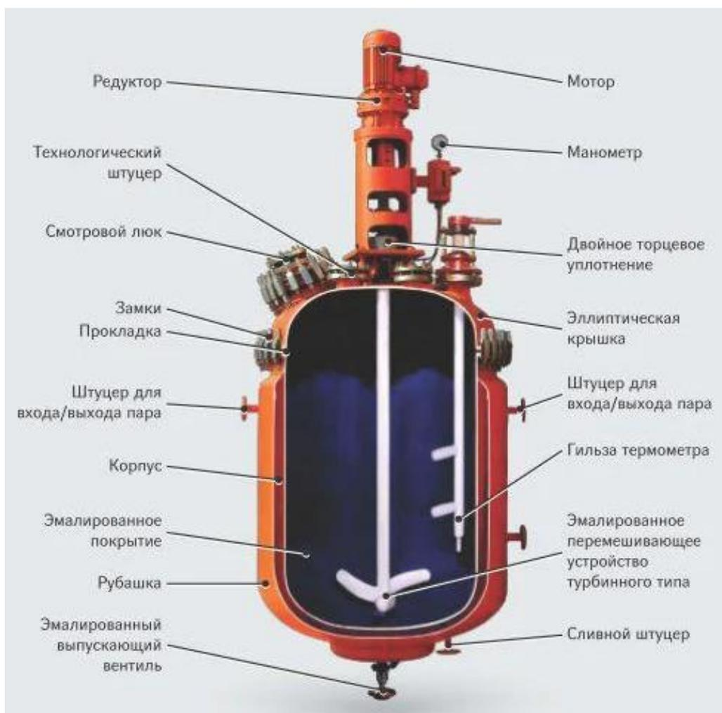
Рисунок 1.4 Основные элементы емкостного реактора [24]
