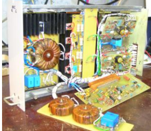
Рис. 20. Модуль конвертора сброса.
