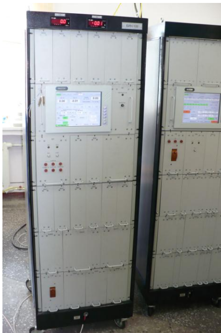
Рис. 22. Блок имитации нагрузки на шину питания СЭП 100 В, БИН-100.
