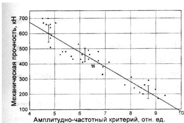
Рис.1. Градуировочная зависимость для определения прочности образцов бетона по амплитудно-частотным параметрам электромагнитного отклика.
