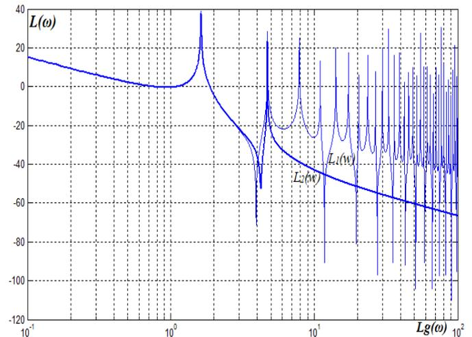
Рис. 2. ЛАЧХ исходной  $L_1(\omega)$  и аппроксимирующей  $L_2(\omega)$  передаточных функций
