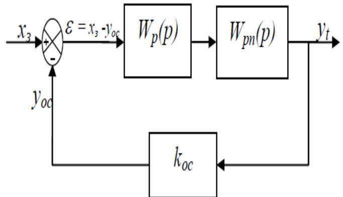
Рис. 1. Схема системы управления объектом с РП
