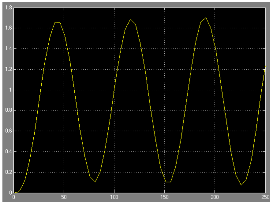
Рисунок 15 – Переходный процесс с постоянной амплитудой
