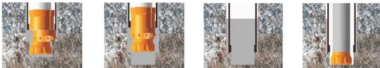
Рисунок 3.4 –Технология бурения системой Odex
