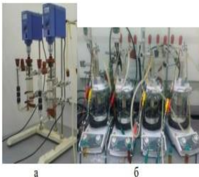
Рисунок 23 - Появление установок для испытания свойств коррозионной стойкости: а) Установка гравиметрических испытаний б) Установка электрохимических испытаний.
