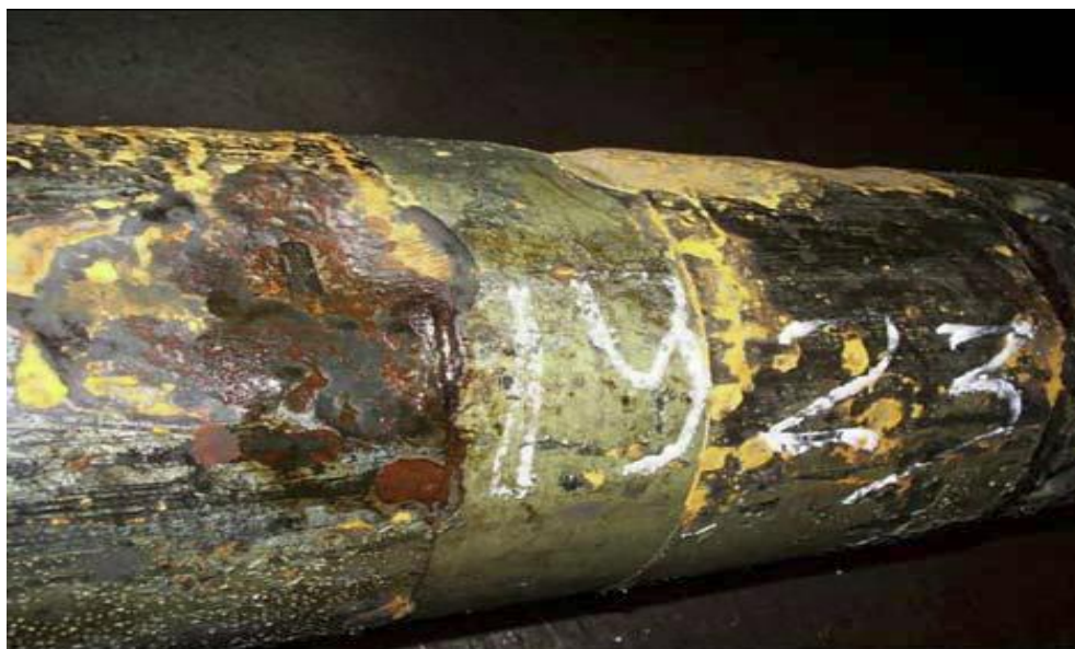
Рисунок 5 – Характер коррозионного повреждения корпуса погружного электродвигателя УЭЦН
