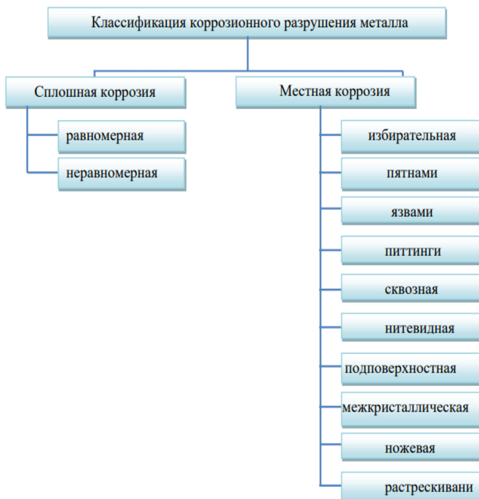
Рисунок 8 – Характер коррозионных разрушений
