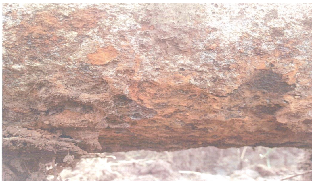
Рисунок 3 – Коррозия НКТ в нагнетательной скважине сточной воды произошла снаружи и изнутри.
